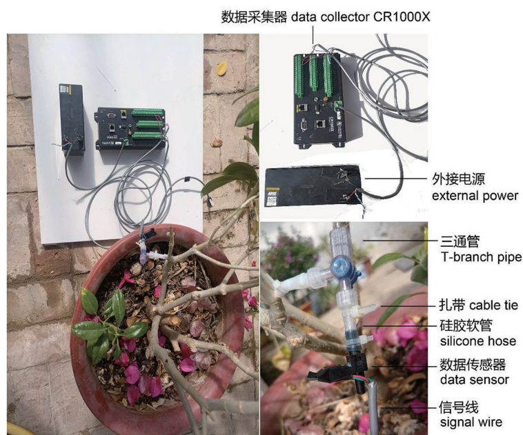
图2 电子压力传感器测定根压的实物图
