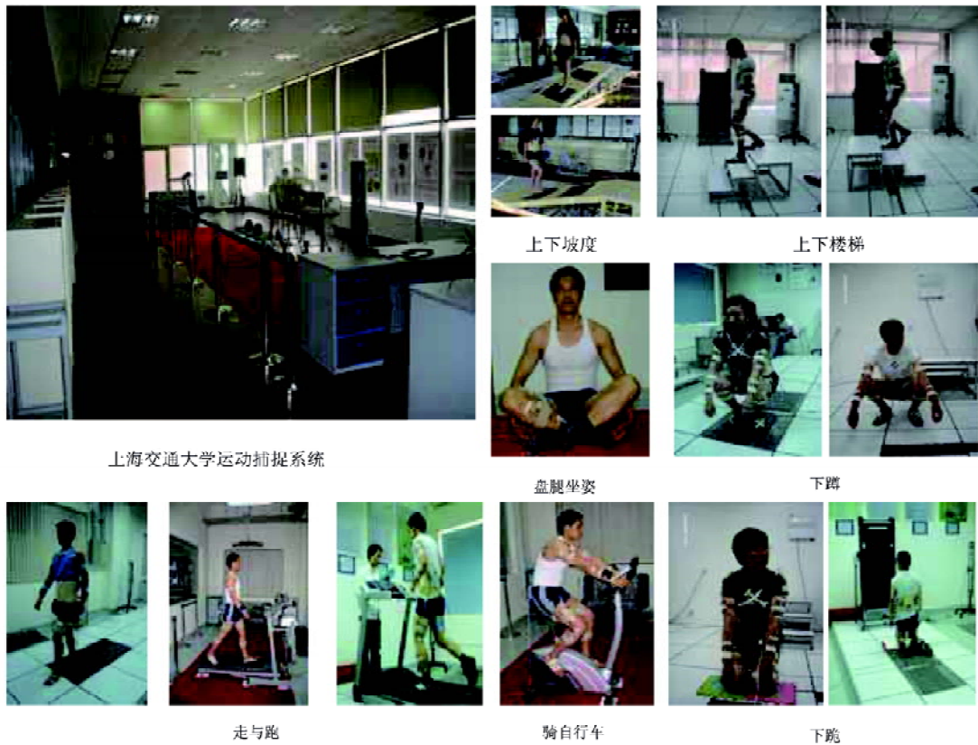
图 3 人体骨肌系统生物力学实验平台与典型行为运动测试
